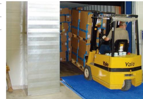
Механические откидные мосты служат для организации погрузочно-разгрузочных мест с использованием автопогрузчика. Компания DoorHan изготавливает мосты двух видов - стационарные и скользящие. Мост, имеющий скользящую конструкцию, позволяет проводить погрузочные работы поочередно в нескольких проемах за счет передвижения от одной точки разгрузки к другой.
